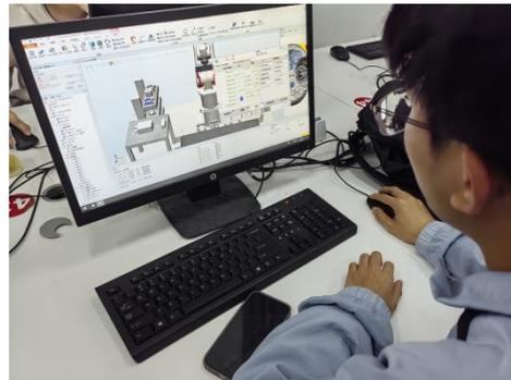
对学生来说，作为初学者同时对机器人不熟悉，学生操作实物机器人存在困难也存在安全隐患，为确保安全同时为提高学生学习效率，在学生实际操作机器人前，采用 RobotStudio 软件进行仿真教学，让学生快速了解工业机器人的基本操作，待学生熟悉基本仿真操作才进行实物操作，降低了安全风险并有效提升了学生的学习效率。
